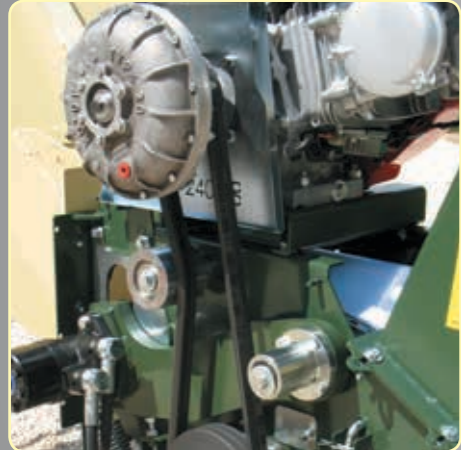
Trasmissione a cinghie con giunto idrodinamico per motore a benzina Belt transmission with hydrodynamic joint for petrol engine Transmission par courroies avec accouplement hydrodynamique pour moteur à essence Transmission por correas con acoplamiento hidrodinámico para motor de gasolina Riemenantrieb mit hydrodynamischer Kupplung für Benzinmotor Overbrenging door V-snaren met hydrodynamische koppeling voor benzinemotor Ременная трансмиссия с гидродинамической муфтой для версии с бензиновым
