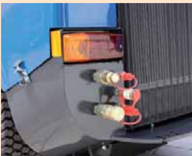
Zadní hydraulické spojky jsou dobře přístupné.
